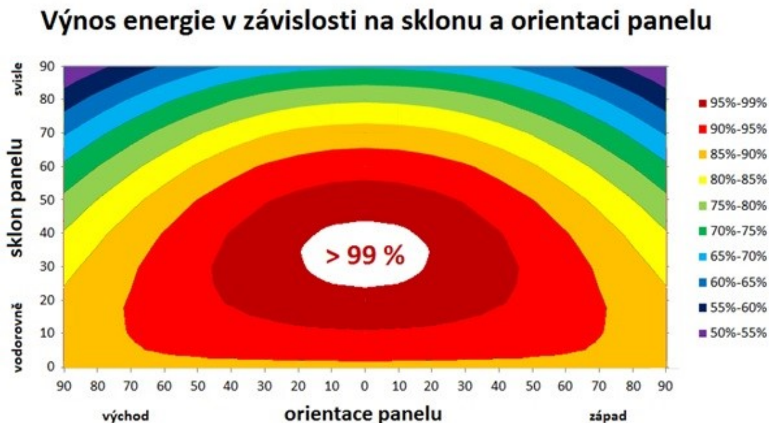
Obrázek 21 – Přibližná orientace a sklon panelu pro maximální výnos energie v ČR 63
