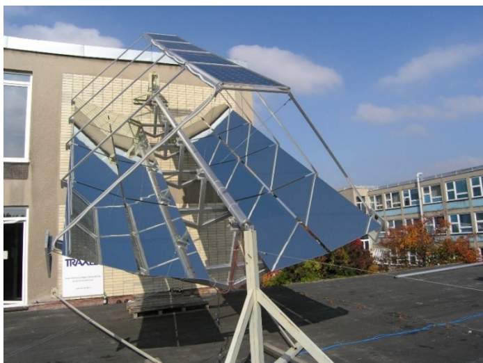
Obrázek 11 – Oboustranný solární panel s pohyblivým automatickým stojanem a koncentrátorem záření 41
