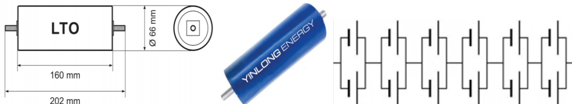
Obrázek 64 – Technický výkres akumulátoru vlevo, vybraný akumulátor ve prostřed 183 , paralelně sériové zapojení článků 2P6S vpravo 184
